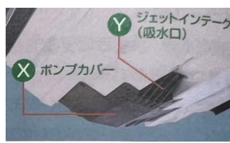
トレーラーへの引き上げ 海上監視 PWC の下部にあるジェットインテーク 5) 推進力を得るための構造 5)
